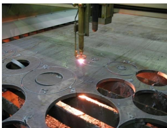
Рисунок 4. Вырезание кольцевой заготовки методом плазменной резки
