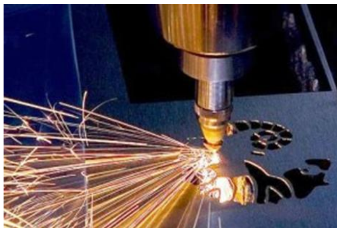
Рисунок 6. Фотография процесса лазерной резки при вырезании сложного профиля Источник:[5].
