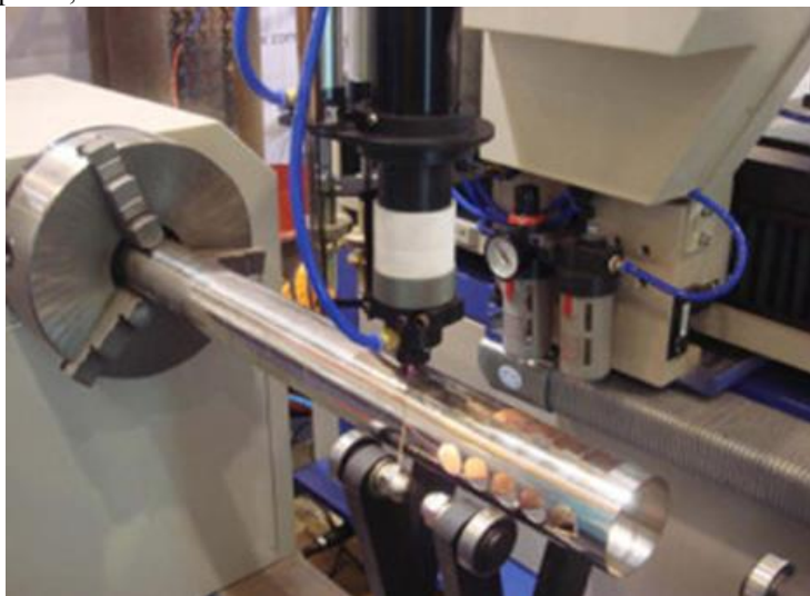
Рисунок 12. Фотография процесса лазерной резки (вырезания отверстий в трубной заготовке) Источник:[5].
