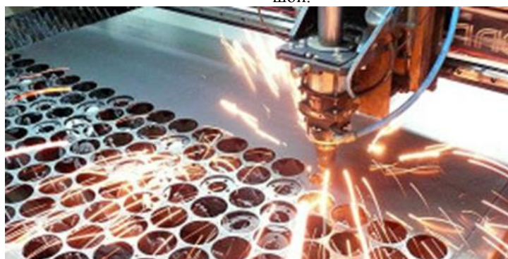
Рисунок 7. Фотография процесса вырезания цилиндрических заготовок лазерной резкой Источник:[5].
