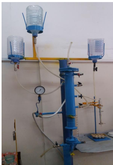
Рисунок 3 – Экспериментальная установка для создания водоизолирующего экрана и определения проницаемости до и после закачки гелеобразующего состава. 1-стояк; 2- цилиндр (основная рабочая часть установки); 3- емкость для жидкого стекла; 4, 5- емкости для высокоминерализованной пластовой воды; 6- краны; 7- манометр; 8, 10- фланцевые соединения; 9- резьбовая часть (для снятия установки); 11- емкость для жидкости.
