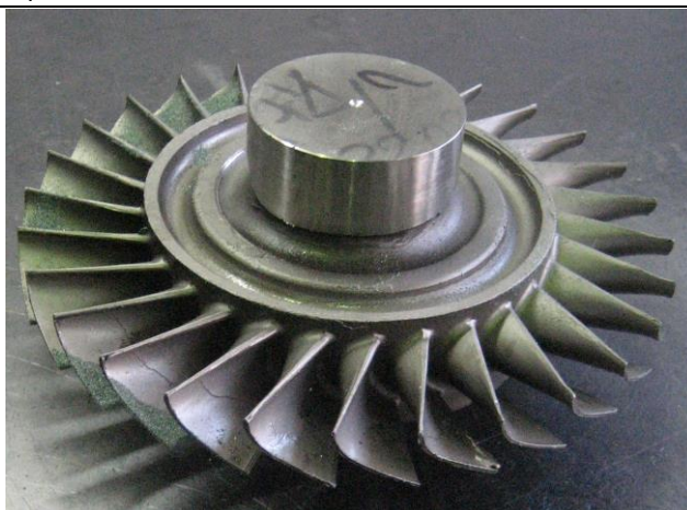
Рисунок 1 – Опытный образец детали (колесо турбины), использованный при проведении исследований.
