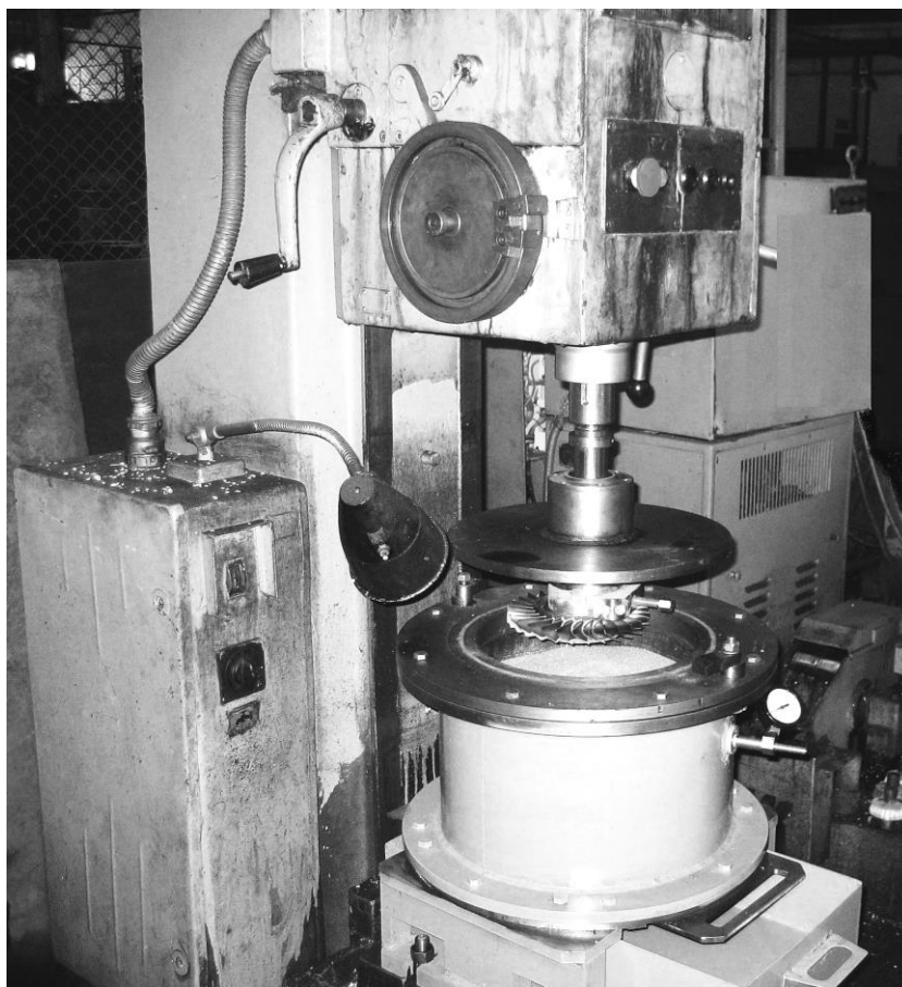
Рисунок 2 – Общий вид варианта промышленной установки для полирования деталей предлагаемым камерным способом в уплотненной обрабатывающей среде.
