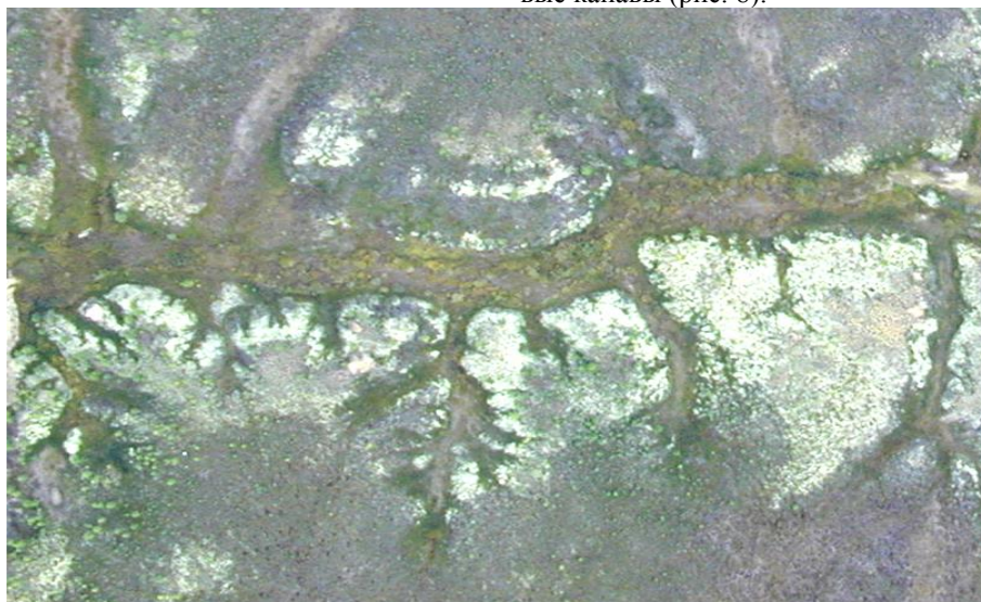
Рис. 7. Овраги, заложенные по системе морозобойных трещин (аэрофотоснимок масштаба 1:5000)
