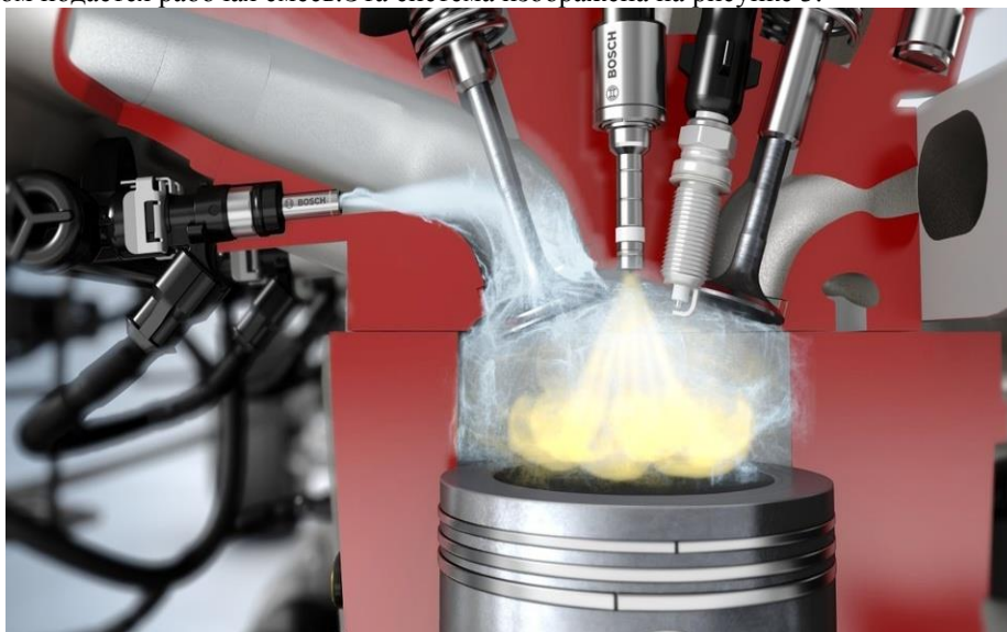
Рисунок 3 – Непосредственный впрыск водо-метанола в двигатель [4, 5].
