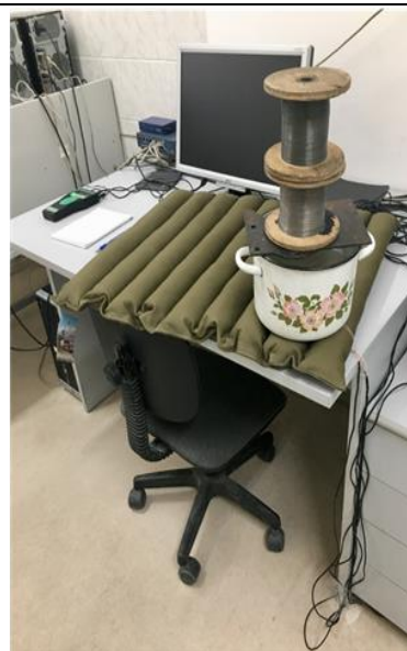
Рис.3 Установка для исследования тепловых потоков
