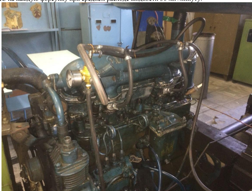
Рисунок 6 – опытный образец установки впрыска – водо-метанола в двигатель.
