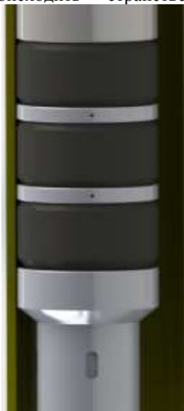
Рисунок 1 Эксцентричное расположение пакерной системы в стволе скважины
