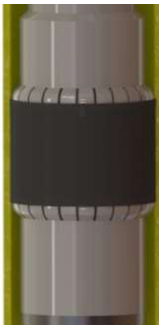
Рисунок 5 Посадка пакера с узлом раздвижных опор обеспечивающего центрирование в скважине
