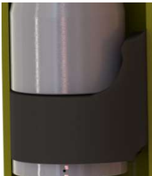
Рисунок 2 Выдавливание резиновых манжет в межтрубное пространство при возникновении перепада давлений
