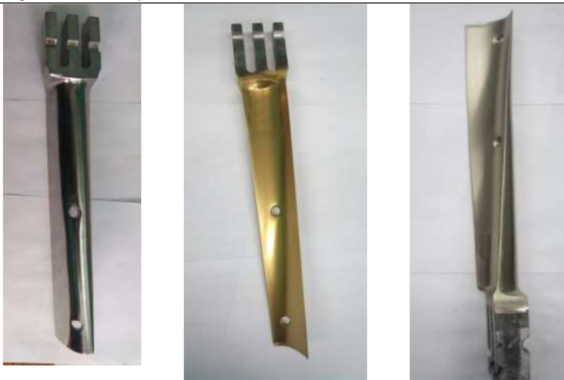
Рисунок 5 Турбинные лопатки без покрытия (а), с нитрил титановым покрытием (б) и с покрытием CrNiTiZrCu (в)
