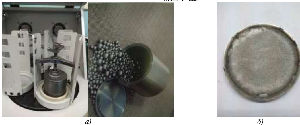
Рисунок 4 Микропорошки металлов смешивались и помещались в мелющий стакан планетарной шаровой мельницы (а), состав затем сушился в вакууме и при помощи пресс-формы прессовался в плоский диск диаметром 100 мм и толщиной в 5 мм (б)
