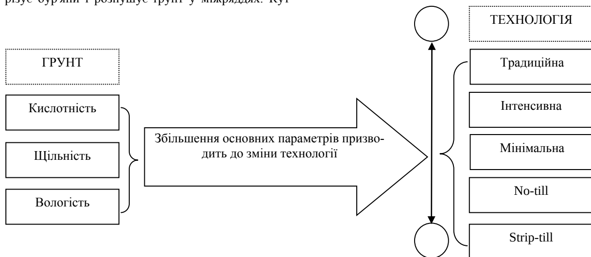
Рис. 2. Залежність технологій від ґрунтових характеристик
