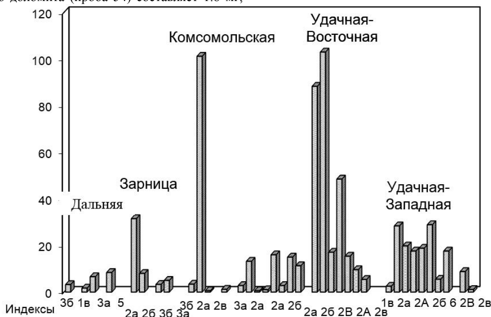
Рис. 4. Содержание алмазов в автолитах, массивной, автолитовой кимберлитовых брекчиях в трубках Дальняя, Зарница, Комсомольская, Удачная-Восточная, Удачная-Западная.
