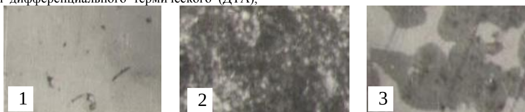
Рис.1. Микроструктуры сплавов системы \text{InAs}_2\text{Se}_4 - \text{In}_6\text{As}_4\text{S}_3\text{Se}_9 . 1-5 мол. %, 2-40 мол. % и 3- 60 мол. % \text{In}_6\text{As}_4\text{S}_3\text{Se}_9 .
