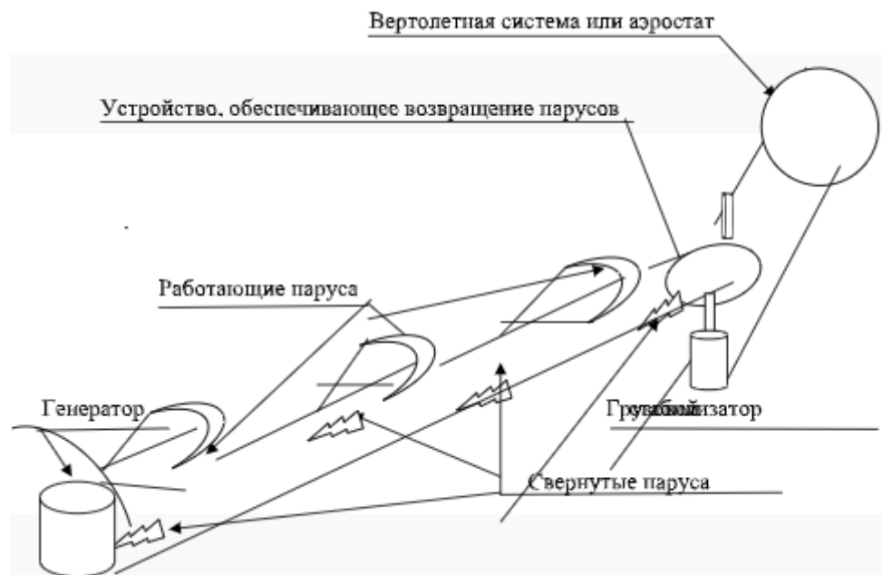
Рисунок 3. Схема парусной ветроустановки.
