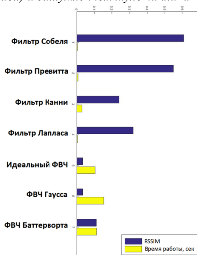
Рис. 7. – Гистограмма количественных оценок качества фильтрации изображений, зашумлённых комбинированным шумом.
