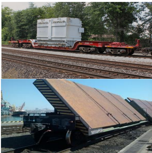
Рисунок 2. Мощные транспортеры для перевозки тяжеловесных грузов.
