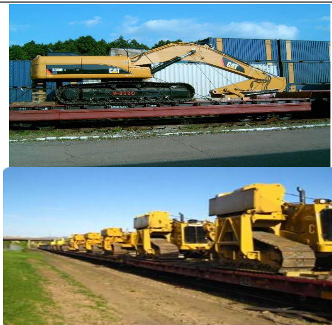
Рисунок 3. Расположение гусеничного транспорта на платформе
