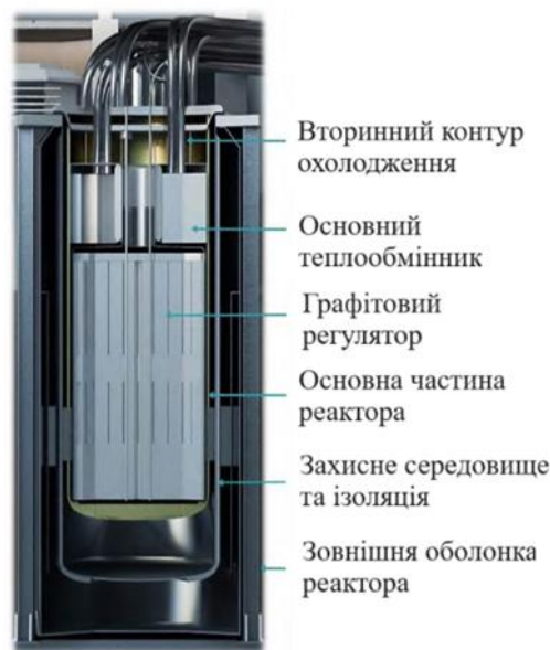
Рисунок 5 – Вигляд реактора Integral Molten Salt Reactor в розрізі
