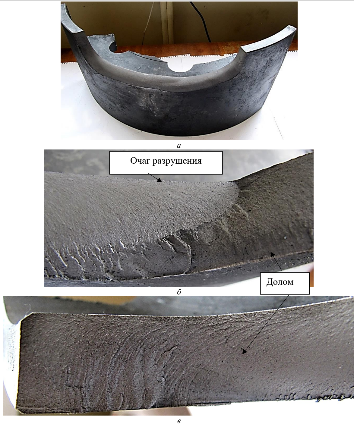
Рис. 4. Образец «Шкив тормозной 30М.2332.001»: а – общий вид; б – морфология излома; в – долом
