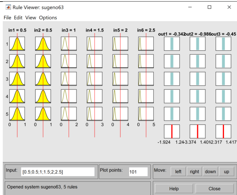
Рисунок 2. Правило (Rule Viewer) в модели Sugeno: визуализация логического вывода для шести входов и трёх выходов
